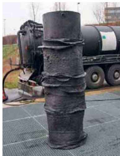
Užsikimšęs koalescencinis filtras: susilpnėjęs vandens pralaidumas, atskirtuvą reikia valyti ir prižiūrėti
