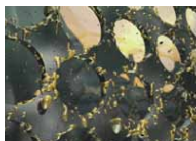
Maži lengvųjų skysčių lašeliai, dėl skirtingo tankio neatskirti nuo vandens, nusėda ant koalescencinio elemento, kur jungiasi tarpusavyje. Lengvųjų skysčių lašeliams susijungus į pakankamo dydžio lašus, jie pradeda plūduriuoti ir pakyla virš vandens
