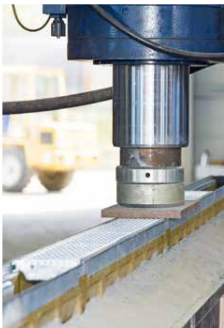
Sandarumo tikrinimas po ilgalaikės apkrovos imitavimo
