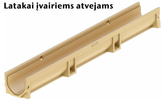
Euroline 2.0 latakų korpusas pagamintas iš polimerbetono. Galima važiuoti automobiliu.
