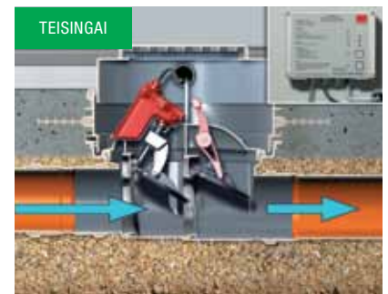
Pakelti uždoriai automatinuose atbuliniuose vožtuvuose, skirtuose nuotekoms su fekalijomis
