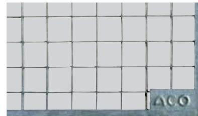
30 x 30 mm akučių tinklėlio grotelės, skirtos vaikščioti (iki 1,5 kN)
