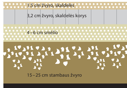
Lengvųjų automobilių apkrovoms atlaikyti ruošiamas 15–25 cm stambaus žvyro pagrindas, ant kurio pilamas ir sutankinamas 4–6 cm smėlio sluoksnis.
