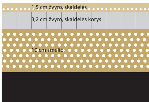
Pėsčiųjų ir dviračių takams reikalingas 10 cm storio smėlio pagrindas
